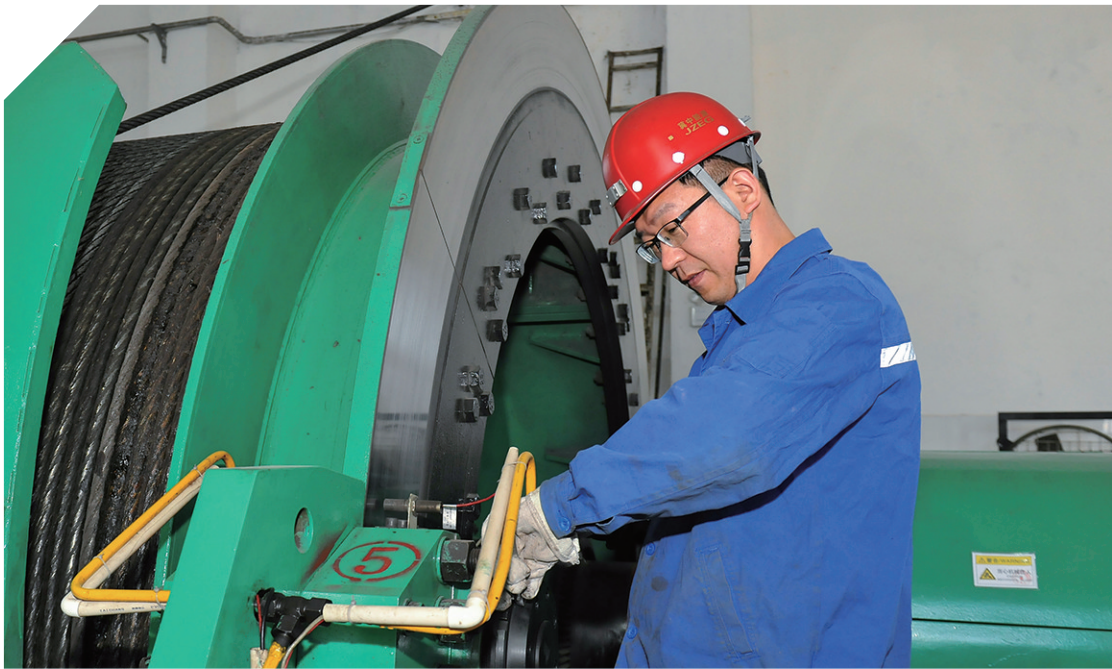
9月22日,冀中能源股份有限公司东庞矿西庞井动力科职工在检修主提升机。为守牢设备安全运行关口,该矿推行机电设备“汽车式保养”,落实日周月分级检修制度,配套专项检查清单,发现隐患及时处置,以设备可靠运转夯实矿井安全生产根基。杨建富 摄
