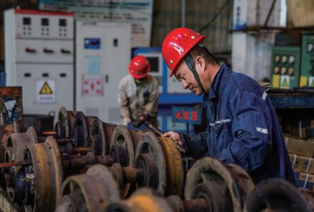
今年以来,开滦股份林西矿业公司进一步抓实挖潜提效、节支降耗工作,为全面提高设备管理水平。组织人员参与修旧利废工作,对旧矿车及矿车轮对进行修复,发挥矿车旧零件和配件的再利用价值,不断节约矿车投新成本。图为该公司员工在修理矿车轮对。崔奕 信明师摄
