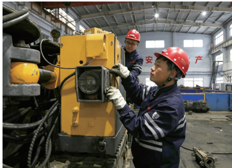
9月份,冀中股份章村矿围绕开掘全力上进尺的生产实际,抓采掘设备维保,加大隐患排查力度,提高现场安全生产标准化运行水平,确保各项任务目标圆满完成。图为该矿机修厂职工在检修矿用掘进机。
