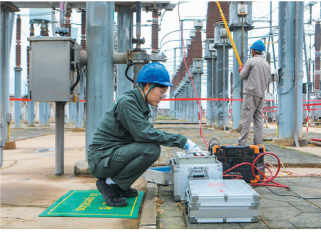
试验人员对电流互感器进行介损测试工作。 任鹏宇 摄
