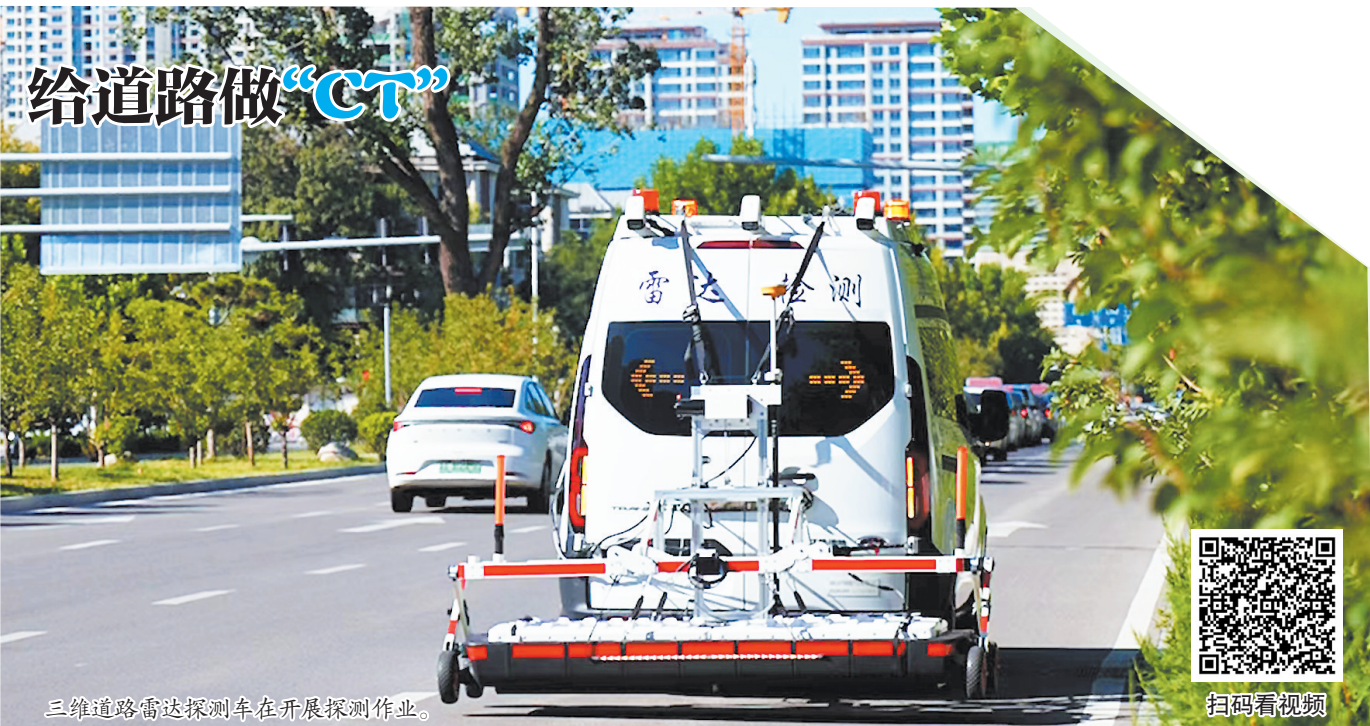
三维道路雷达探测车在开展探测作业。
