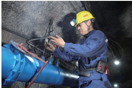
9月2日,冀中能源峰峰集团羊东矿抽放区职工在测定抽采参数。该矿针对矿井在线抽采监测计量装置存在安装和测量复杂、测量结果有误差等问题,制作出多功能瓦斯抽采参数精准测定装置,实现了人工测量、在线计量、孔板流量计量多种数值现场进行比对,有效保证了抽采参数测定的准确性。 尹行 摄
