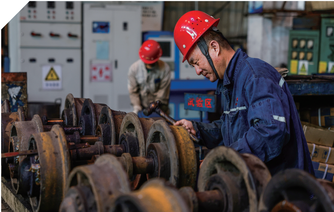
今年以来,开滦股份林西矿业公司进一步抓实挖潜提效、节支降耗工作,对旧矿车及矿车轮对进行修复,发挥矿车旧零件和配件的再利用价值,节约矿车投新成本。图为该公司员工在修理矿车轮对。 崔奕 信明帅 摄
