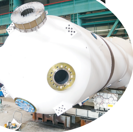
哈电集团(秦皇岛)重型装备有限公司的工人在组装核电蒸汽发生器设备。 王继军 摄
