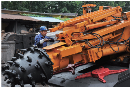
8月25日,冀中能源股份有限公司东庞矿机修厂职工在调试全新的掘锚一体机。今年以来,该矿持续加大装备升级力度,在各掘进头面逐步打造以掘锚一体机为核心、自移式机尾为纽带、单轨吊为运输保障的“掘支运”一体化协同快速掘进作业线,以开掘源头效率提升保证矿井安全生产。 杨建富 摄
