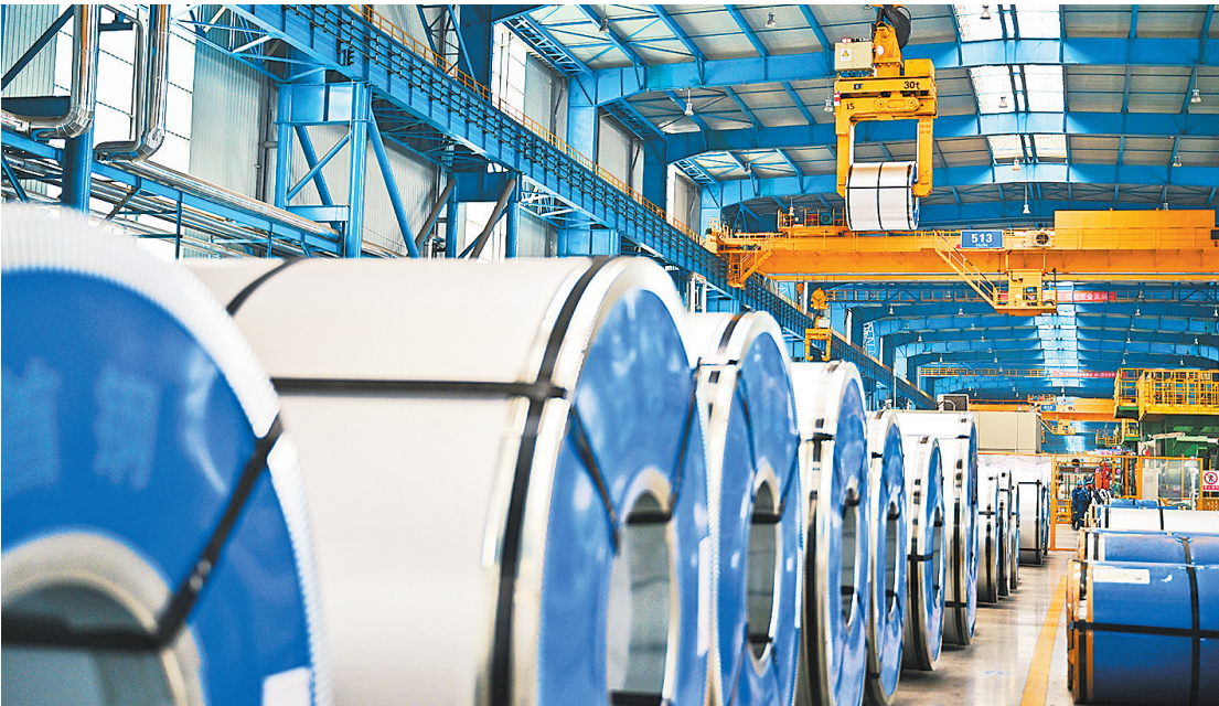
首钢智新电磁材料（迁安）股份有限公司吊装机械在吊运电工钢。
