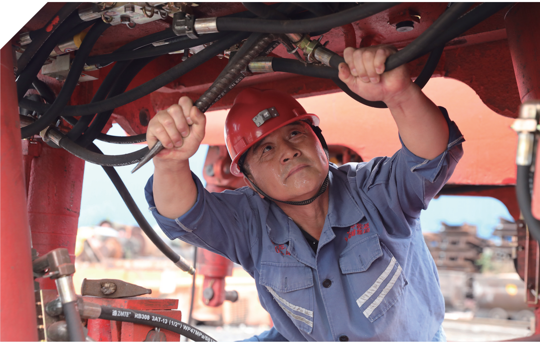
7月28日,冀中能源峰峰集团九龙矿职工在对入井液压支架进行细致检修。该矿结合生产实际与设备管理要求,严把机电设备入井关口,强化预检检修与隐患治理,确保设备安全可靠、合格达标,为井下安全稳产奠定基础。 杜鹏龙 摄
