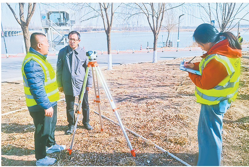
石家庄水文中心技术人员架起水准仪,对正定水站三个基本水准点做交叉校核。记者 吴新光 摄
