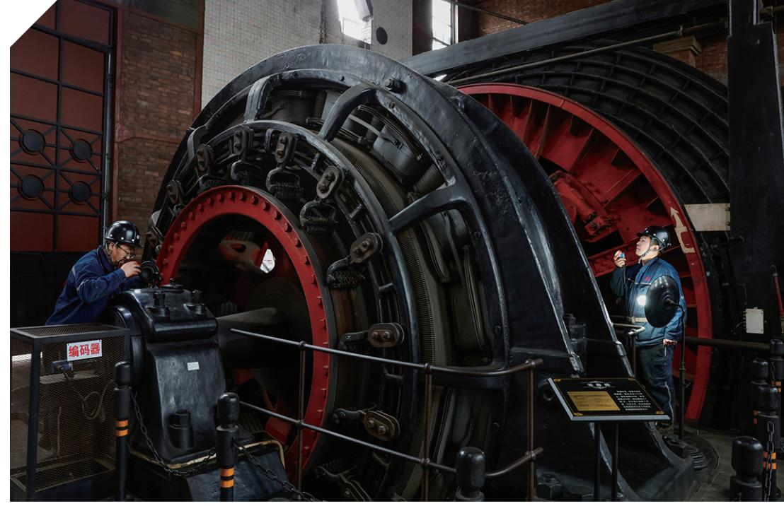
1月以来,开滦集团唐山矿业公司通过检查线路连接可靠性、校验传感器灵敏度、优化控制程序参数,进一步提升提升系统自动化操控精度,实现提升机运行状态实时监测、异常情况精准预警,为智能化矿井建设筑牢机电保障。图为检修人员在对提升机控制系统进行检修调试。
