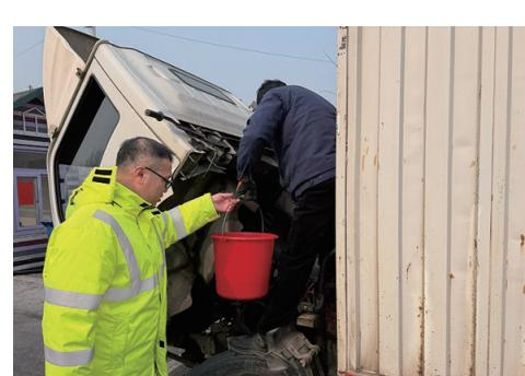
2月4日,一货车行驶至河北交投沿海高速公路有限公司南戴河站路段,水箱水温异常飙升。该公司员工携带应急工具,疏导车辆至安全区域,并从便民服务点提水为水箱散热器喷淋降温,避免了事故发生。
