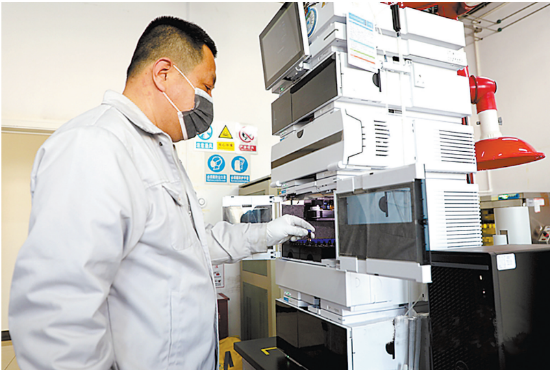
鼎材科技工作人员把发光材料放进液相色谱仪测试。 记者 烟成群 摄
