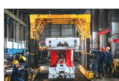
今年以来,开滦股份林西矿业公司严抓设备安全关,聚焦井下设备全周期管理,对新投用、检修后设备开展核检检测,发现隐患当场处置。同时,组织人员围绕液压系统、设备构造进行详细检查。图为该公司员工在检查设备。
