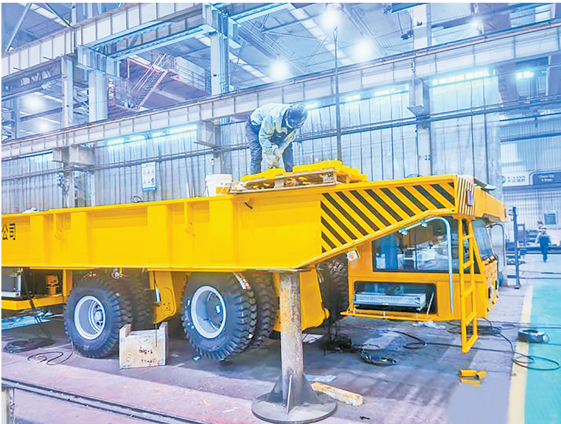
天业通联公司工人在组装船厂平板车。
