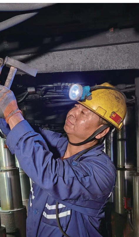
峰峰集团九龙矿持续加大各类设备检修维护力度,严格落实“点检定修制”和日周月检制,扎实开展设备动态巡检,实行设备包保,全方位排查处理安全隐患,确保设备完好率和安全可靠运行。图为该矿职工在对工作面液压支架进行检修维护。 杜鹏龙 吴朝阳 摄
