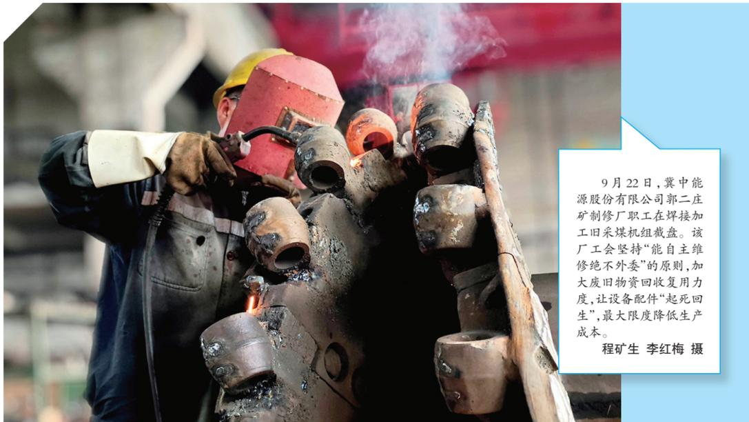
9月22日，冀中能源股份有限公司郭二庄矿制修厂职工在焊接加工旧采煤机组截盘。该厂工会坚持“能自主维修绝不外委”的原则，加大废旧物资回收复用力度，让设备配件“起死回生”，最大限度降低生产成本。
