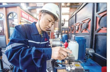
开滦集团唐山矿业公司推行“日历化”周期性检修制度,建立完备的设备全生命周期档案,在各提升井主轴等关键部位安装温度、振动传感器,实现运行状态实时监测,形成“高频次基础保养+周期性深度维护+科学化状态监护”的立体化保障体系。图为该公司员工在对提升系统进行检修。 庞英德 崔奕 摄
