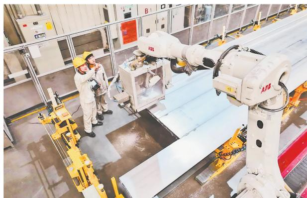
在中车唐山机车车辆有限公司的智能制造基地里,日产三辆复兴号车体正以毫米级精度完成装配。这家轨道交通装备制造标杆企业,通过数字孪生、人工智能、工业互联网等技术重塑高铁智造逻辑——从设计端的“未造先知”到生产端的“一键智造”,再到运维端的“全球守护”,该公司以全链条数智化转型实践,为中国高端装备制造制造业升级提供了成功样本。图为中车唐山公司车体事业部工程师正在查看动车组侧墙智能打磨工序情况。云钊 摄
