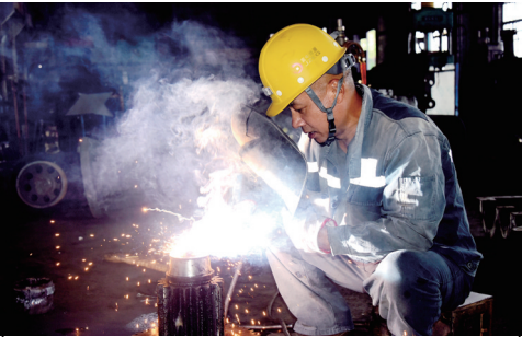
9月1日,冀中股份郭二庄矿焊工在精补焊减速机二轴。该矿积极倡导精修细补理念,以过硬的技术赋予设备零部件“第二次生命”,降低成本。 程矿生 李红梅 摄
