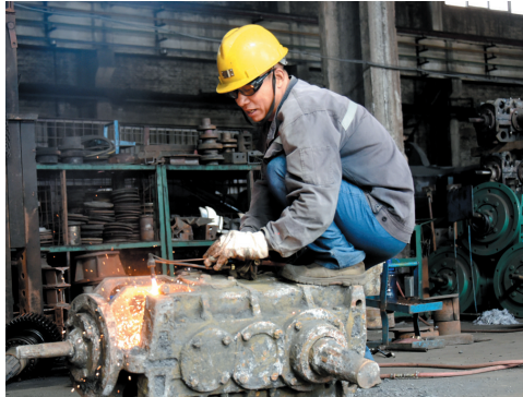
8月12日,冀中股份郭二庄矿制修厂维修工正在修复减速箱。三季度以来,该厂工会以班组为单位,积极开展“修旧利废、降本增效”劳动竞赛,制定奖罚办法,每旬表彰通报,充分调动职工降本工作的积极性和创造性。程衍生 曹丽飞 摄
