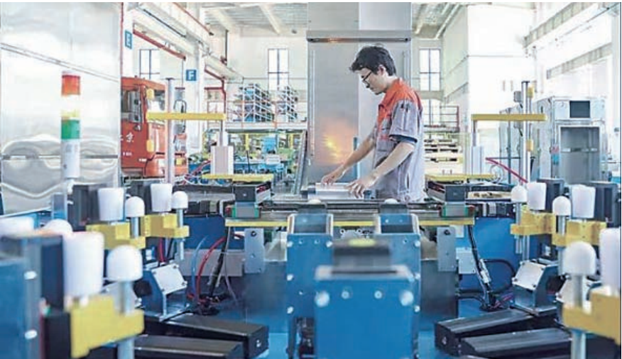
在英辉(大厂)自动化技术有限公司生产车间内,工人在调整玻璃托架万能工装参数。
