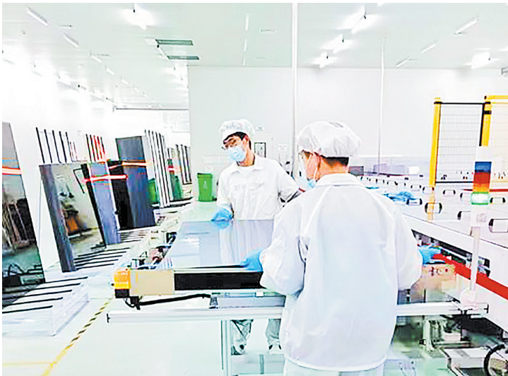
工作人员正在对碲化镉薄膜发电玻璃进行质检。 长城网·冀云客户端记者 张隽 摄
