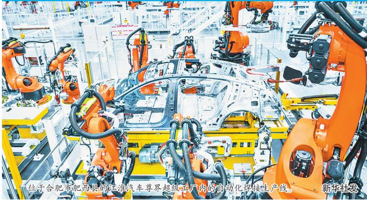
位于合肥市肥西县的江淮汽车蔚来超级工厂内的自动化焊接生产线。新华社发
