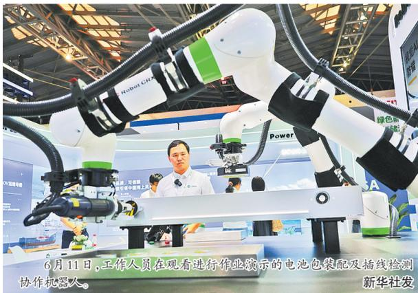
6月11日,工作人员在观看进行作业演示的电池包装配及插线检测协作机器人。
