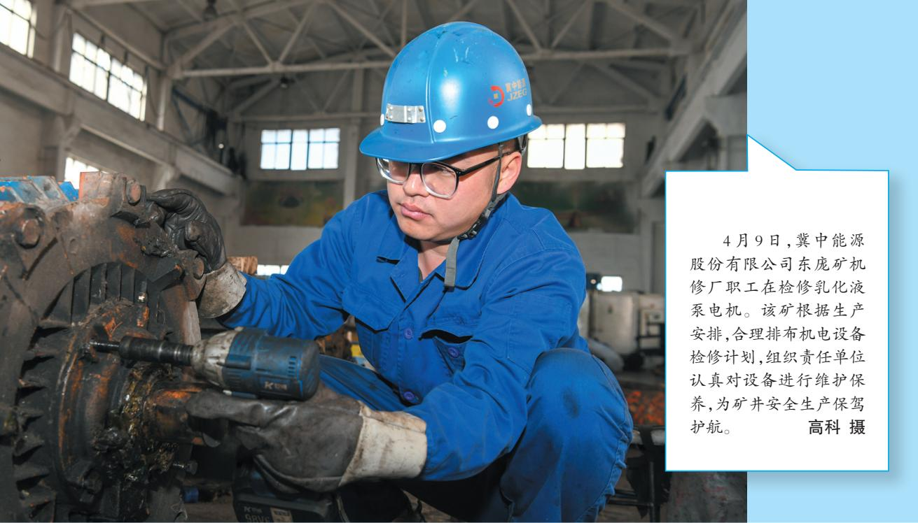
4月9日，冀中能源股份有限公司东庞矿机修厂职工在检修乳化液泵电机。该矿根据生产安排，合理排布机电设备检修计划，组织责任单位认真对设备进行维护保养，为矿井安全生产保驾护航。高科 摄
