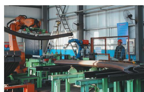
今年以来，开滦股份吕家坨矿坚持AI智能化目标，通过“智能管控中心+自动化物流”模式，实现型钢上料、弯折、焊接、装车全流程机器人操作，人工转为实时监控与质量跟踪，从而达到减人提效的目的。图为该矿员工在巡视机器人装车情况。
