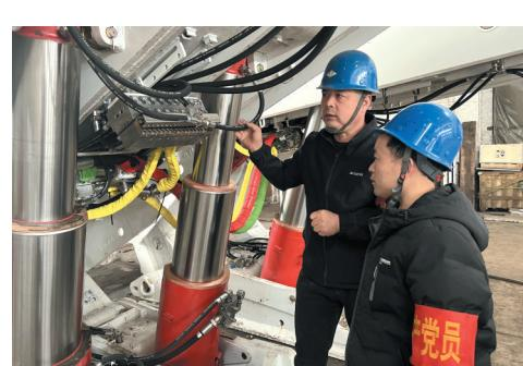
近日,开滦集团林西矿业公司组织党员管技开展设备隐患大排查活动,对综采支架、掘进机等大型设备进行全方位检查,降低设备事故率。图为该公司员工在对综采液压支架进行“瘦身”检查。
