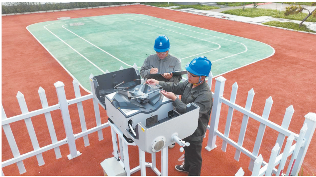
石家庄供电公司加快电网巡检数字化智能化转型速度,推进智能设备规模化应用,选取深泽县为试点,布设7座无人机机巢,每座巡检半径5公里,在河北南网地区首次实现县域无人机自主巡检全覆盖,开启县域电力智能运维新时代。 康伟 魏莎莎 摄
