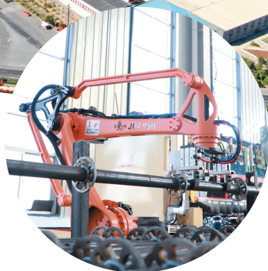
河北鹏鑫管道装备集团有限公司盘扣脚手架工序智能流水线。
