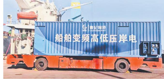
本报讯（通讯员郭新丹）日前，由河北港口集团曹港集团联运码头创新研发的全国首套纯电自行移动式高低压岸电系统，在曹妃甸港区601泊位为“和泰通1”轮完成供电试运行成功。
