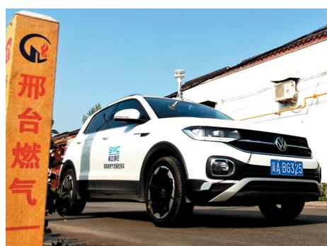
日前,邢台市住房和城乡建设局组织各燃气公司采取精度更高、效果更好的PPB级燃气激光检测车,对农村气代煤地埋中低压燃气管道进行泄漏检测,保障燃气管道安全稳定运行。 张利海 摄
