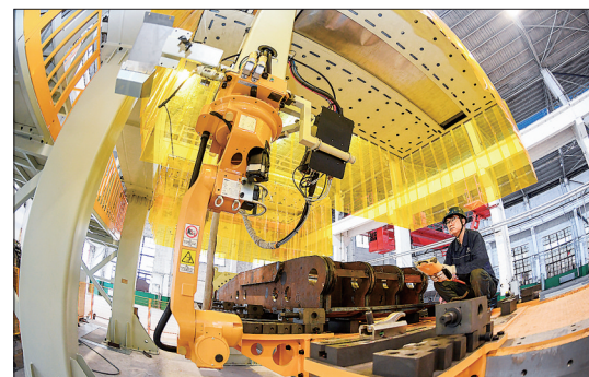
新春伊始,开滦集团铁拓重工公司铆足干劲,复工复产率达100%,奋力夺取第一季度“开门红”。该公司通过项目建设、设备升级和工艺流程调整优化生产布局,提高生产流程智能化和高效化水平,实现企业现代化管理水平和效益快速提升。图为技术工人操控矿用液压支架焊接机器人生产线。 马骏 崔奕 摄
