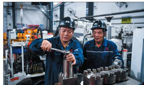
近日,开滦集团唐山矿业公司紧密结合设备寿命期管理,坚持遵循日检、周检、月检“三检制”,根据不同周期,有侧重地进行设备检修,并填写设备隐患排查表,对存在隐患的设备超前判断设备的“病症”,详细制定检修计划,尽快使设备达到完好状态。图为该公司员工对钻探设备进行检修。
