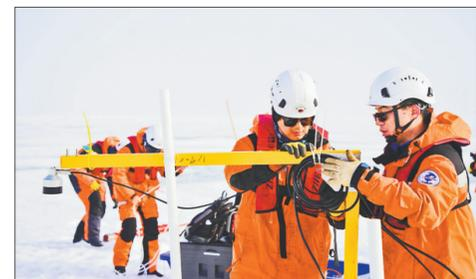
8月12日,科考队员在布放海冰物质平衡浮标。8月12日,由自然资源部组织的中国第13次北冰洋科学考察队乘坐“雪龙2”号极地科考破冰船航行至北纬81度附近海域,正式开始海冰综合调查作业。
