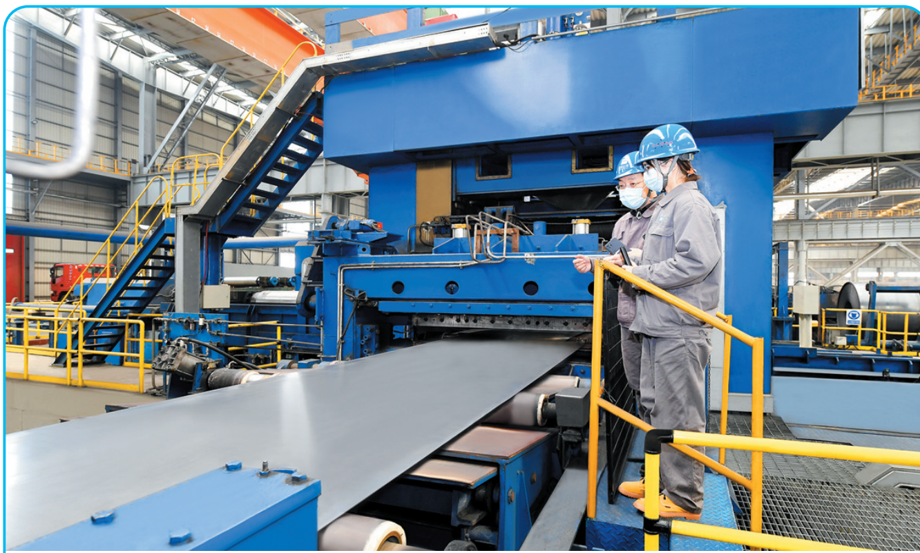
4月3日,河钢集团唐钢公司热轧事业部技术人员在分析工艺优化后的车轮钢产品质量情况。该公司抢抓市场机遇,不断加大高端产品提质增量攻关力度,积极对接客户对车轮钢产品强度、成形性和表面质量等方面的个性化需求,通过调整轧制负荷、加强卷取温度控制、优化平整工艺参数等措施,不断提升产线高端制造水平和创效能力。3月份,该公司车轮钢产品销量环比提升83.21%。 通讯员 赵辉 付小娜 摄
