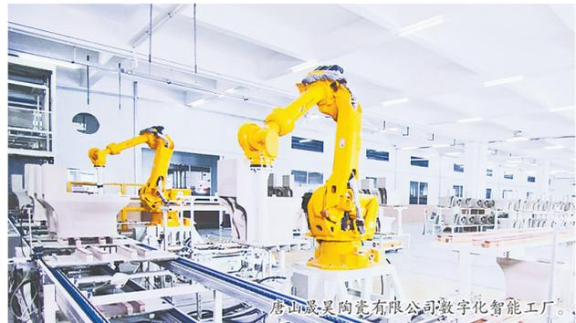
菌智能卫生器具生产线。运用MES智能管理系统,从信息化角度提高产品质量、生产效率。同时,运用数字孪生技术,通过虚实结合的数字化仿真系统,建立数字化动态模型,实时反映设备的实际运行情况,提高生产稳定性。
