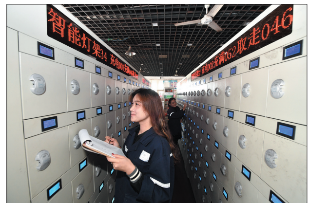
日前,开滦唐山矿业公司将老式矿灯充电架更换成新式智能充电柜,新设备能够实时提供快速、准确的使用信息,满足了煤矿矿灯管理现代化、智能化、信息化及安全化的需要。图为该公司员工在对智能灯架进行日常巡检。 通讯员 庞英德 何超摄
