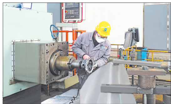
河钢集团唐山公司组成以党员为骨干的攻关小组,以备件的高周期使用推进产线成本降低为目标,开展高炉振动筛衬板、辊压破碎机齿套等十余种备件的修复工艺优化,备件使用寿命显著提高。图为河钢集团唐山公司检修分公司公辅修复中心党员正在运用数字铣床修复备件,为下一步的表面强化做准备。 赵辉 靳志伟 摄
