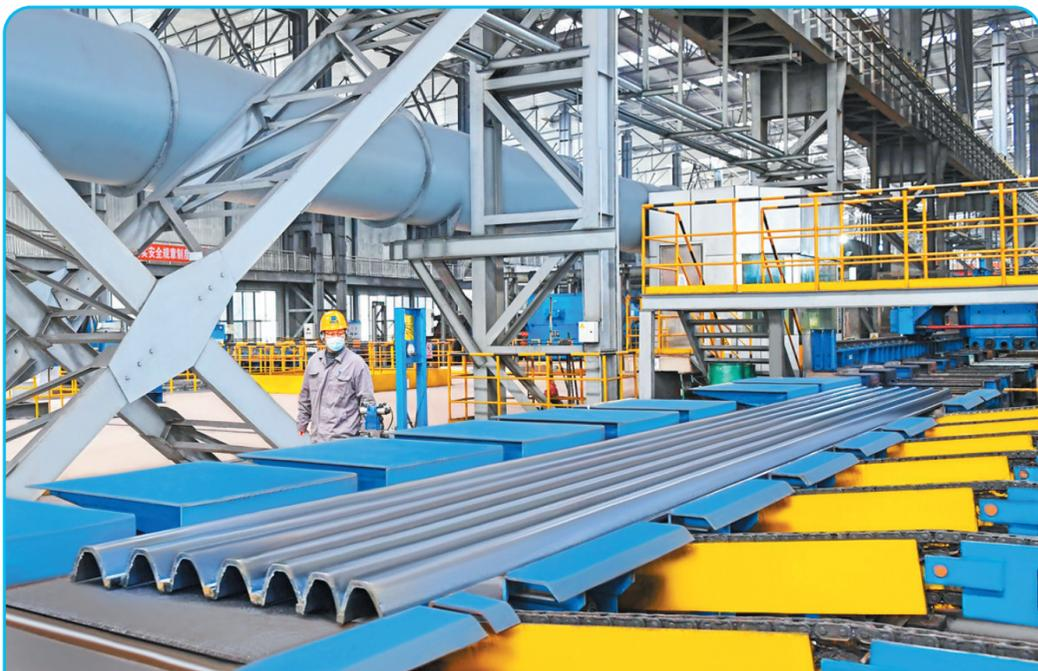
11月16日,河钢集团唐钢公司长材事业部技术人员在查看轧制工艺优化后的U型钢产品质量情况。四季度以来,该公司进一步强化“四个更加关注”,围绕创效能力较好的中型产品不断加大市场调研和客户走访工作力度,积极推动老客户订单增量和新用户开发,根据客户对产品尺寸精度、力学性能和表面质量等方面的个性化、小众化需求,开展轧制工艺优化、改进孔型设计、调整压下量分配等技术攻关,不断提高产品竞争力。10月份,该公司中型产品产量同比提升54.02%。
