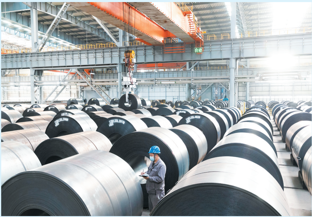
河钢集团唐钢公司充分释放装备工艺、技术水平以及区位优势,积极对标先进企业,围绕品种开发、质量提升、设备管理等方面加大技术攻关力度,依托技术进步丰富产品谱系、提高质量稳定性,提升市场竞争力。图为河钢集团唐钢公司热轧事业部职工在成品库区检查热轧低合金高强度钢产品质量并核对订单信息。 宋东阳 杨玉倩 摄
