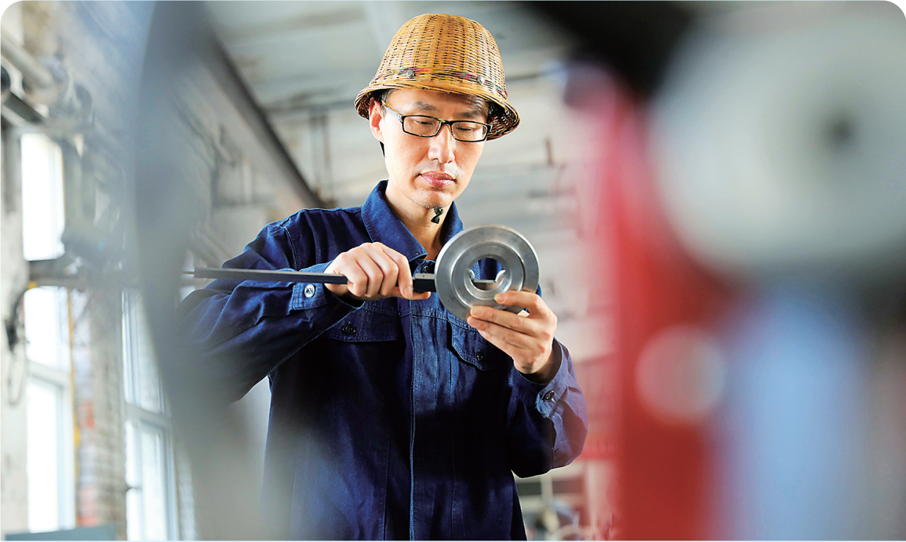
今年以来,开滦集团吕家坨矿业公司以“保安全、提质量”为重点,结合工作实际,开展质量提升活动,通过提高员工质量意识、强化加工过程质量管理等方式,为公司安全生产提供有力保障。图为开滦集团吕家坨矿业公司车工正在用游标卡尺测量轴承压盖口径。 任蕊 摄
