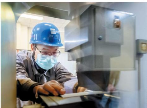
10月19日,河钢集团唐钢公司技术中心技术人员在放置试样准备对工艺优化后的980MPa级超高强度钢进行弯曲性能检测。
