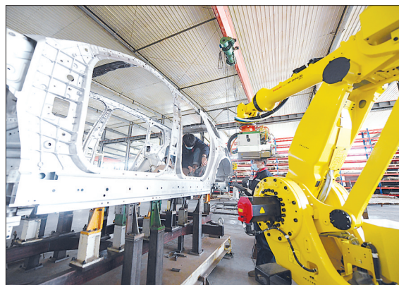
文安县持续推动商贸物流、装备制造、装配式建筑、汽车零配件等一批与京津冀和周边地区建设发展相配套的产业项目壮大成势,加快新旧动能转换。图为在文安县经济开发区宾法(廊坊)新能源汽车制造有限公司,工人正在焊接汽车框架。 郑佳庆 高丹钰 摄
