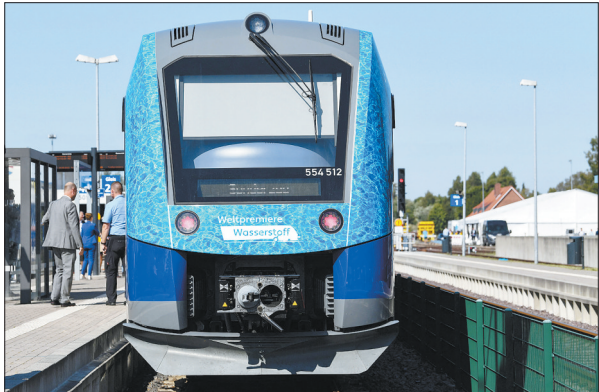
这是8月24日在德国下萨克森州拍摄的氢能载客列车。德国首条运行氢能列车的铁路线路24日在北部下萨克森州正式启用。这些列车使用纯氢气作为燃料，从环境空气中收集氧气，在燃料电池中将这两种气体转化为电能，行驶时只产生蒸汽和冷凝水，且噪音很低。 新华社/法新
