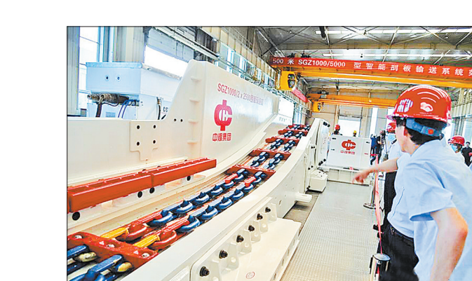
8月4日,由中煤张家口煤矿机械有限责任公司自主研发的国内首台SGZ1000/5000型超长工作面智能刮板输送机下线,并通过由中国工程院院士王国法等专家、学者组成的评审团出厂评议,将交付山东能源内蒙古矿业公司新上海一号煤矿。该刮板输送机整机设计瞄准碳达峰、碳中和目标,实现了自动感知、智能运行、智能监测,以自有技术助力煤炭生产系统结构低碳升级,助力绿色开采和智能煤矿建设。 记者 郑世繁 通讯员 武海笑 陈冠 摄
