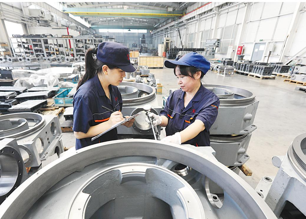
固安县积极承接京津优质产业转移,打造以航空航天、汽车零部件、精密电子、环保设备等为主导的高端装备制造产业集群。目前,该县工业园装备制造企业达110余家,年产值90多亿元。图为该工业园内汉飞思科精密机械制造有限公司质检员对数控机床零部件数据进行对比登记。 门丛硕 摄
