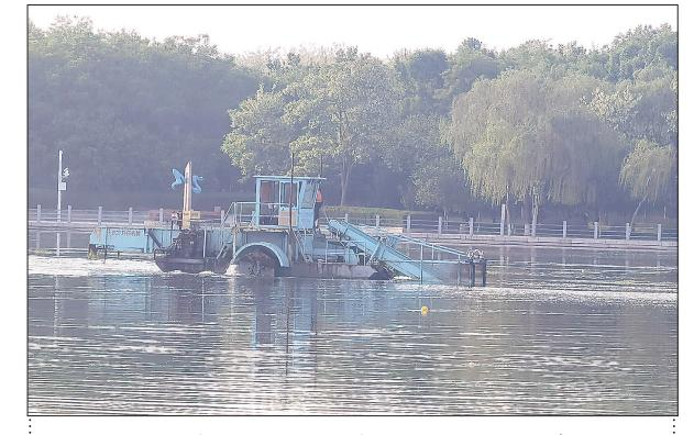
为了保障水质及水体景观质量,避免水草积滞垃圾、高温腐烂等情况发生,石家庄市园林局城市水系园林中心密切关注水草生长情况,科学制定打捞方案,在太平河及西北水系河道内采取增加割草船,加派工作人员等措施,运用“人机结合”的方法,提高水草清理效率,目前日均清理水草约15吨。图为工作人员在驾驶割草船清理水草。
