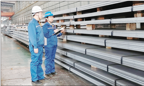
日前,河钢邯钢中板热处理生产线轧机轰鸣。产品用于载重车车厢制作,可使车厢整体减重1/3,使用寿命增加2.5倍,是国家汽车用钢轻量化减重、节能、降碳追求的目标,国内极少企业能够生产。图为河钢邯钢技术人员在检验将要外发的耐磨钢产品质量。 吴兆军 摄
