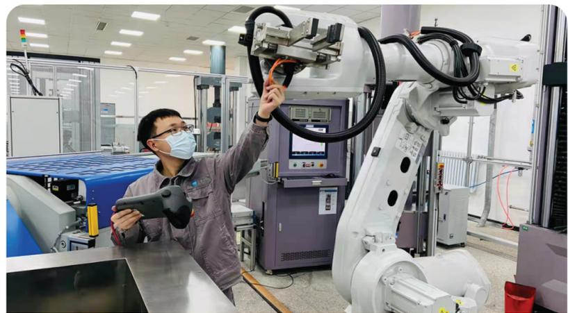
12月3日,河钢唐钢质量管理部长材检验作业区技术员正根据生产检验需求调试机械手参数,保证力学性能自动检测线高效运行。该部坚持以技术升级为保障,将4台拉伸试验机、2台反向弯曲试验机、2台机械手集成在一起,形成全自动检测线,极大提高了检验效率和精度,为公司长材产线的生产、发货提供了及时准确的检测数据支撑。 花竞争 赵炳建 摄
