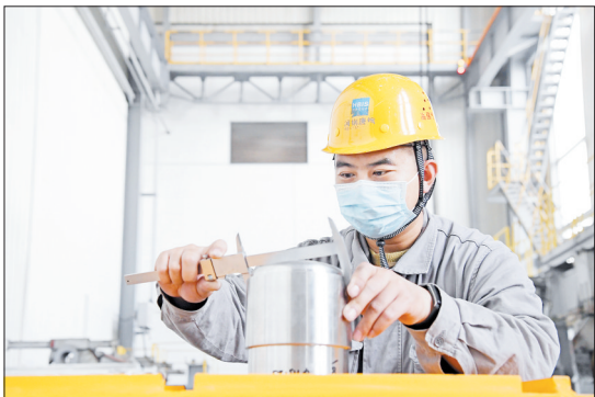
四季度以来,河钢唐钢高强汽车板有限公司党委深入推进“创最佳的业绩、做最好的自己”主题先锋赛,引导广大党员充分发挥先锋模范作用,围绕产品质量提升、提高产线效率等重点工作开展技术攻关,通过优化备件装配工艺、加强板形质量控制等措施持续提升高端制造能力,为企业高质量发展贡献力量。10月份,该公司商品量达到17.7万吨,同比提升15.6%。图为该公司党员对装配工艺优化后的轴瓦轴套备件进行尺寸确认。 赵辉 陈瑞娟 冯立华 摄
