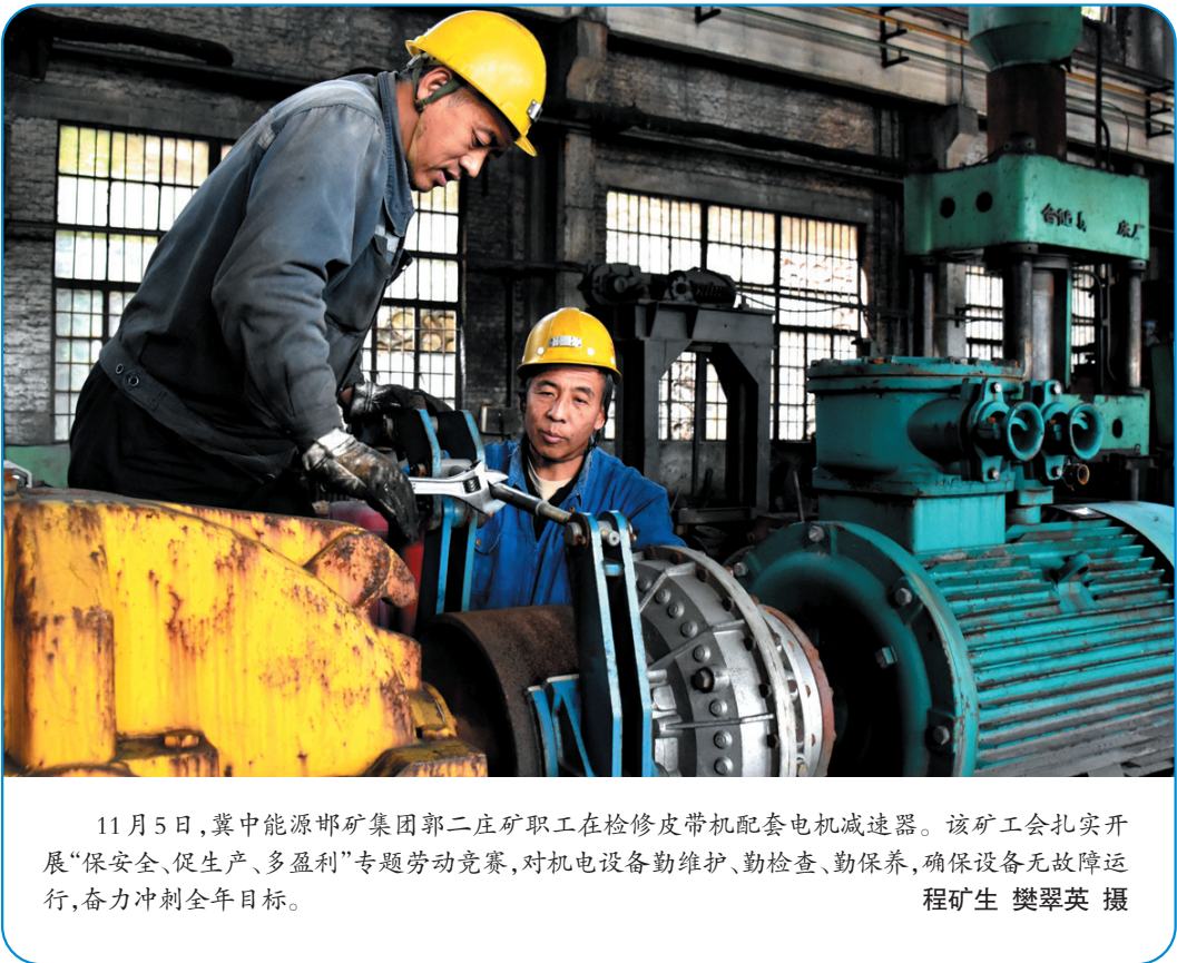
11月5日,冀中能源邯矿集团郭二庄矿职工在检修皮带机配套电机减速器。该矿工会扎实开展“保安全、促生产、多盈利”专题劳动竞赛,对机电设备勤维护、勤检查、勤保养,确保设备无故障运行,奋力冲刺全年目标。
